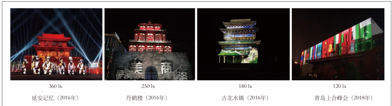
图16 不同照度指标的实际效果对比
